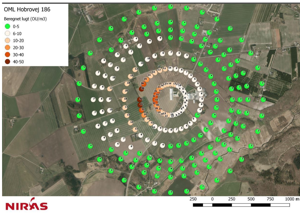
Lugtemission fra husdyrbrug på Hobrovej 186.
